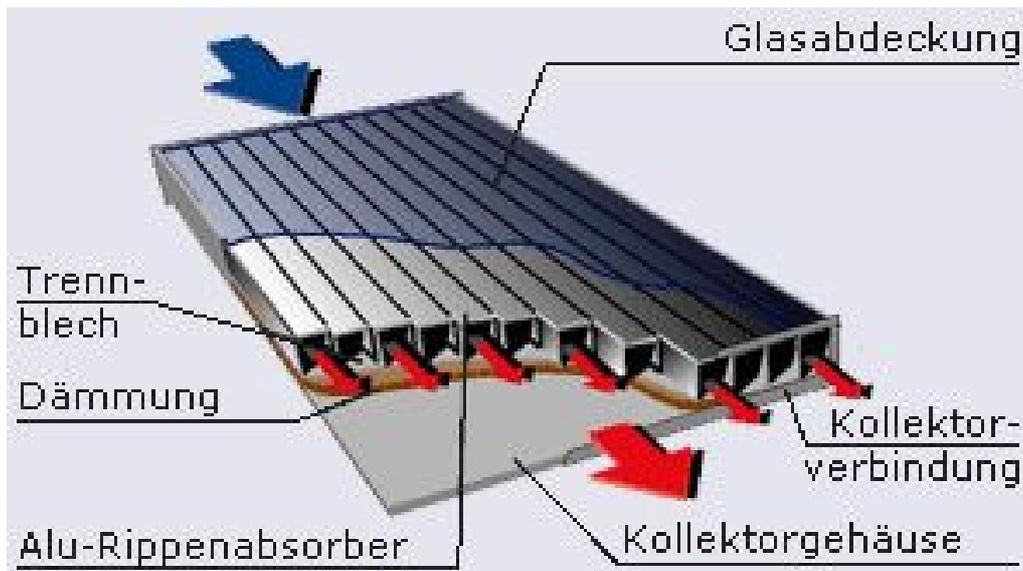
**Abbildung 9: Luftkollektor TopSolar der Firma Grammer Solar [3]**
