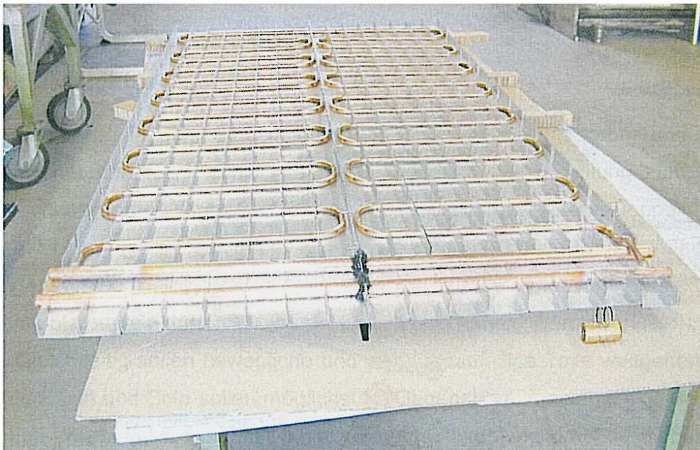
**Abbildung 13: Absorber des SOLAERA-Hybridkollektors der Fa. Consolar [8]**
