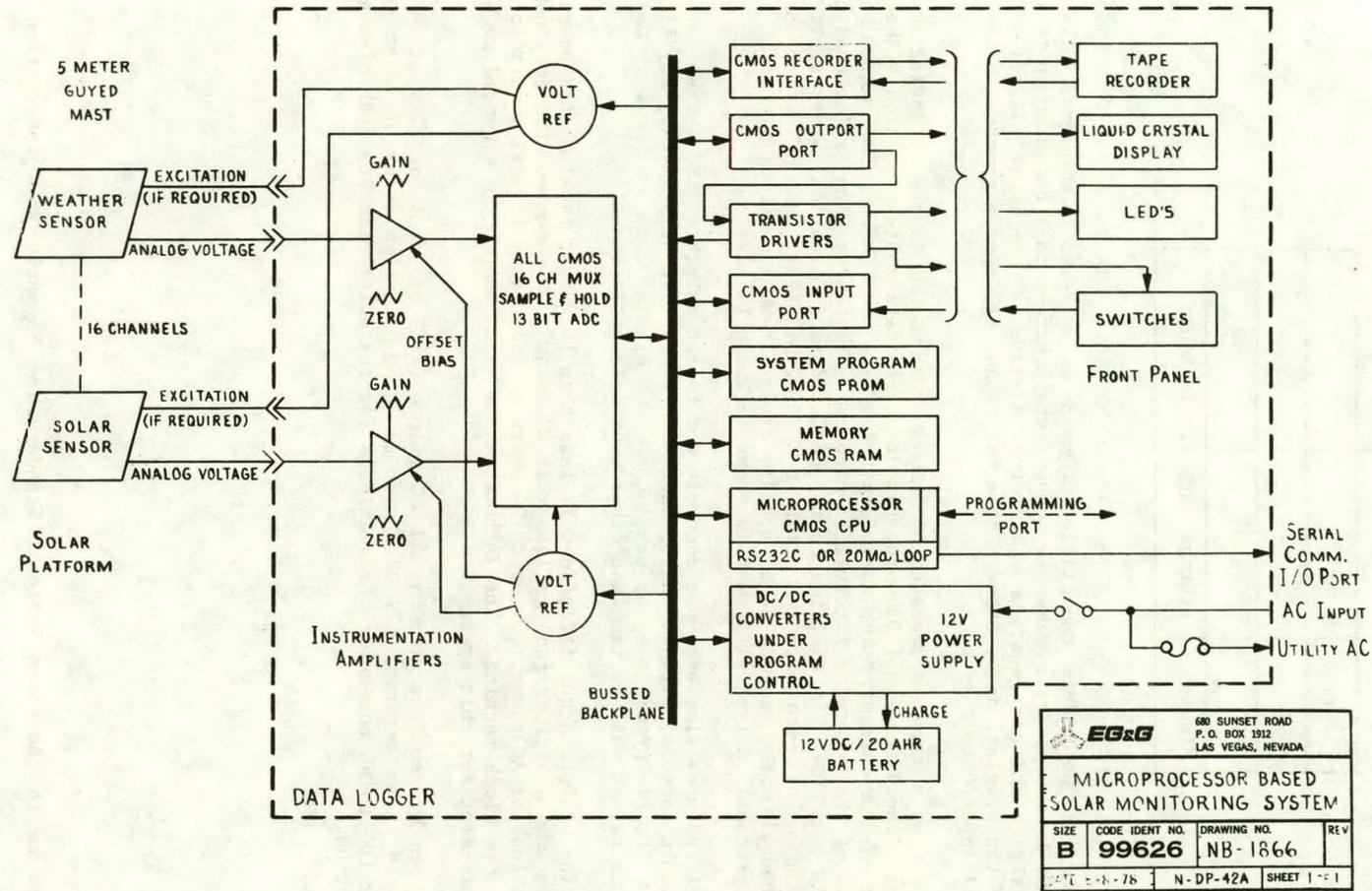
Fig. III-5 DATA ACQUISITION UNIT BLOCK DIAGRAM
